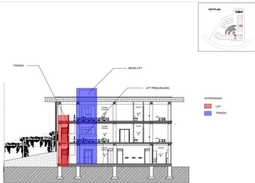
Gambar 64. Rancangan Transportasi Vertikal Sumber : Analisis Penulis, 2020
