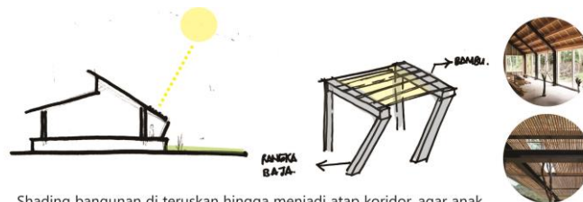
Shading bangunan di teruskan hingga menjadi atap koridor, agar anak dapat nyaman saat lewat / beraktivitas di koridor. Digunakan material baja yang low maintenance mudah di dapat sebagai rangka dan bambu sebagai atap koridor yang juga merupakan sumber daya alam di bantaran sungai.
