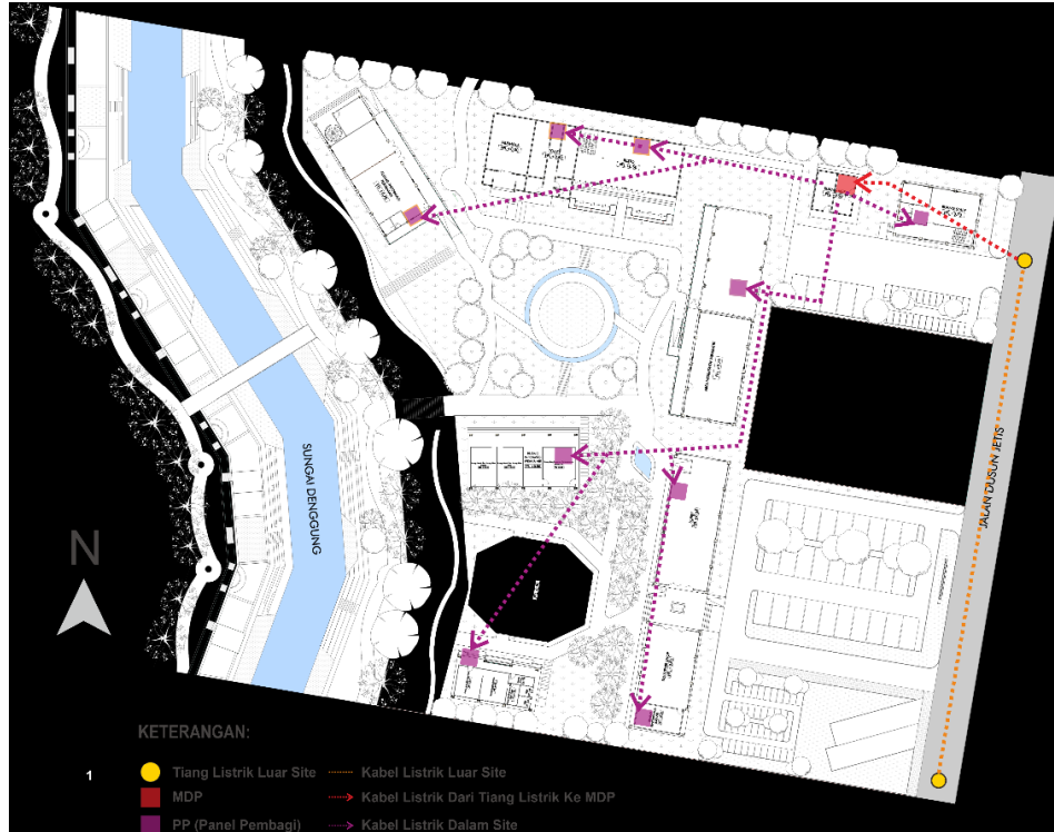
Gambar 5.27 Sistem Penyediaan dan Distribusi Listrik Sumber: Penulis, 2020
