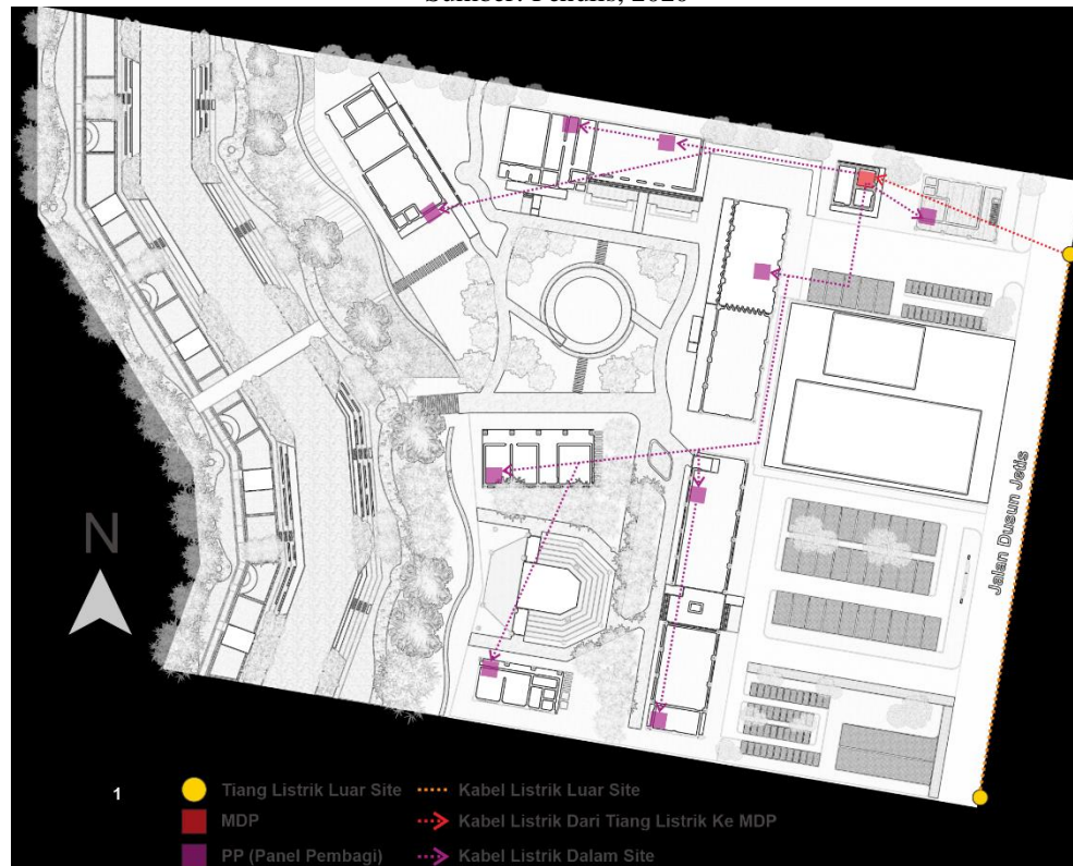
Gambar 4.31 Rancangan Skematik Distribusi Listrik Sumber: Penulis, 2020
