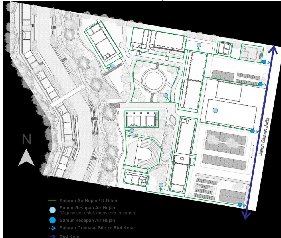
Gambar 4.29 Rancangan Skematik Drainase Air Hujan Sumber: Penulis, 2020
