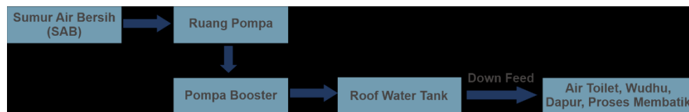
Gambar 4.25 Skema Proses Air Bersih Sumber: Penulis, 2020
