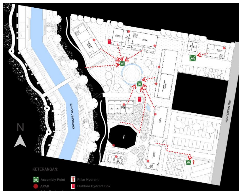
Gambar 5.33 Sistem Keselamatan Bangunan Sumber: Penulis, 2020
