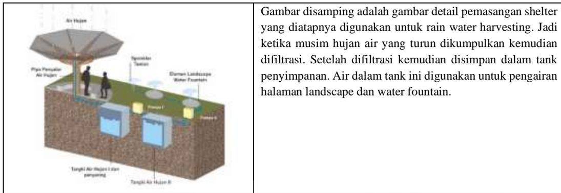
Gambar disamping adalah gambar detail pemasangan shelter yang diatapnya digunakan untuk rain water harvesting. Jadi ketika musim hujan air yang turun dikumpulkan kemudian difiltrasi. Setelah difiltrasi kemudian disimpan dalam tank penyimpanan. Air dalam tank ini digunakan untuk pengairan halaman landscape dan water fountain.
