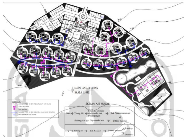
Gambar 5. 16 Jalur, Skema, dan Sistem Air Hujan Sumber : Penulis, 2020
