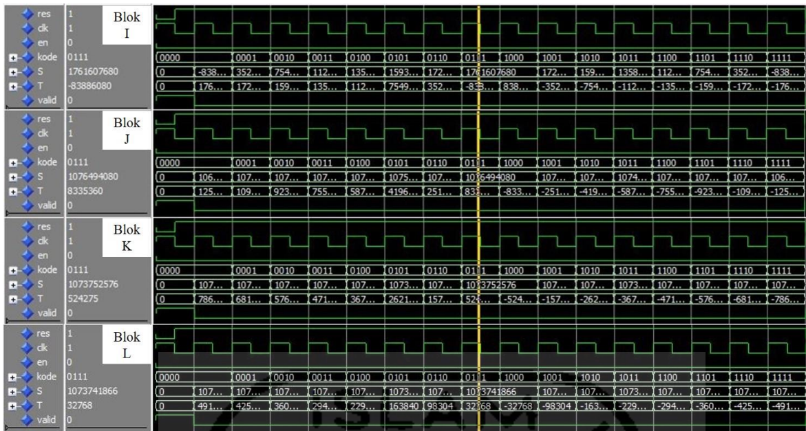
Gambar 4.3 Hasil Pengujian Perkalian Matriks Tingkat 2 dengan Decoder 4-Bit
