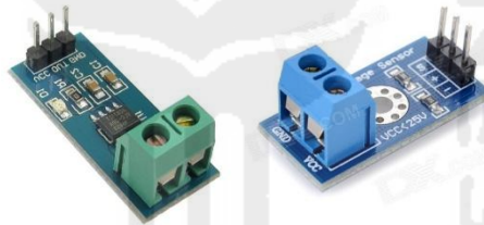
Gambar 3. 4 Sensor ACS712 dan Voltage Sensor
