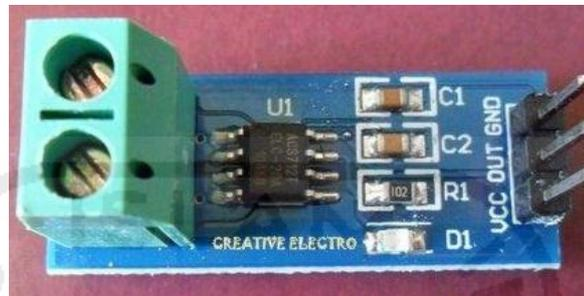
**Gambar 2. 7** Sensor Arus ACS712 5A
