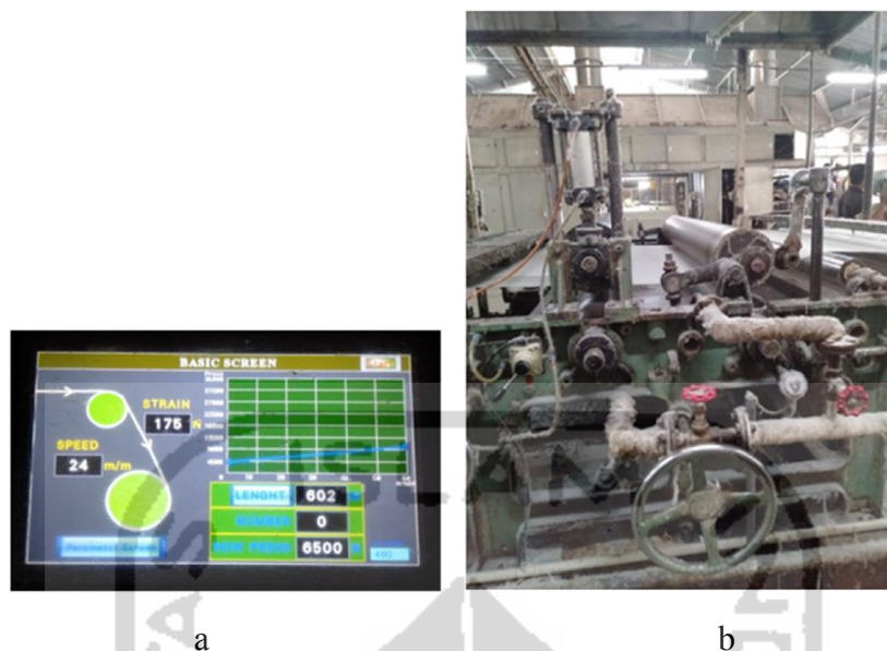
Gambar 2.6. a. Parameter Mesin Kanji, b. Penekan Hidrolis pada Rol Perendam
