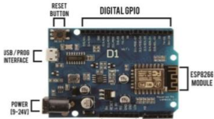
Gambar 2.1. Mikrokontroler Wemos D1
