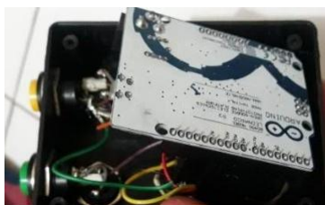
Gambar 4.7 Rangkaian Push Button, Jump Wires dan Leonardo
