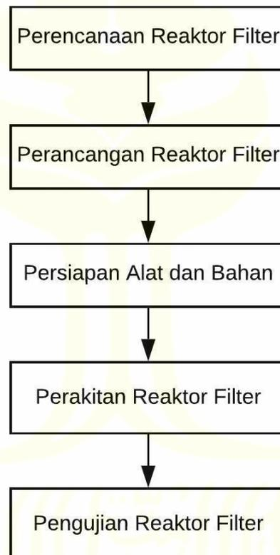
**Gambar 3. 3** Prosedur Pembuatan Reaktor *Eco-Filter*
