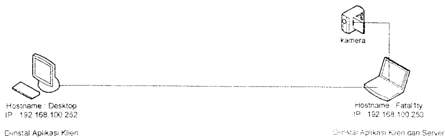
Gambar 6.19 Gambar Konfigurasi Perangkat Keras Untuk Pengujian Video Conference
