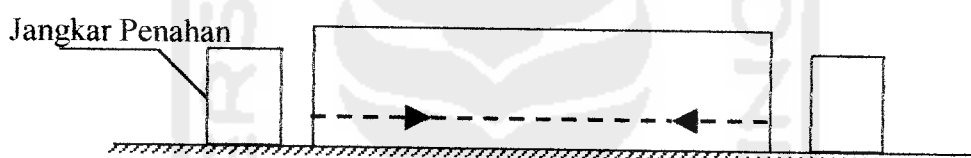
(c) gaya desak dilimpahkan kedalam beton
