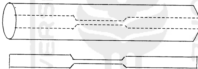
Gambar 4.11 Benda uji untuk uji kuat tarik baja.
