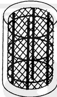
Gambar 4.6 Beton bertulang dengan sengkang dan *wire mesh*
