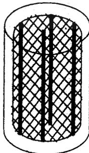
Gambar 4.5 Beton bertulang dengan *wire mesh*
