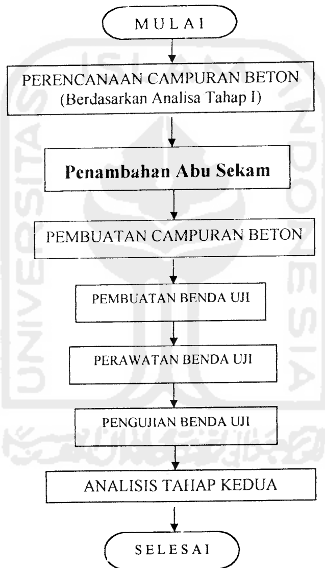
Gambar 4.2 Bagan alir proses pengerjaan beton variasi abu sekam beragregat halus campuran pasir kali dan pasir pantai tahap II
