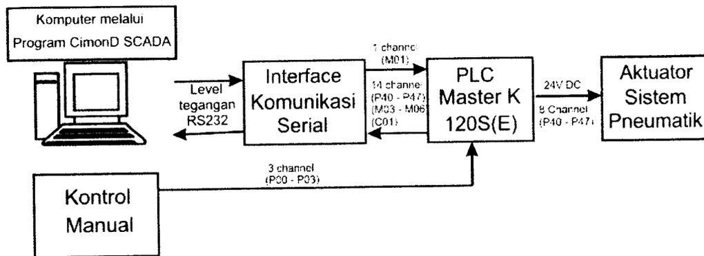
Gambar 3-5 Block diagram perangkat keras sistem
