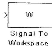
Blok ini menyimpan data dari hasil simulasi ke *workspace* Matlab. Pada saat simulasi, parameter simulasi diatur pada kondisi solver :
