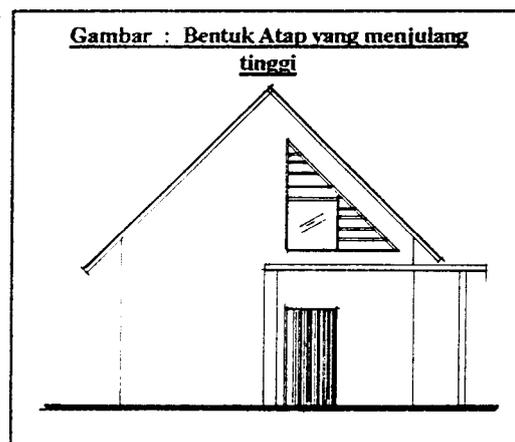
Pengaturan ventilasi horizontal dapat menjadi bagus apabila pada bangunan ada sisi yang sengaja dibuat relatif lebih panas dan ada sisi yang lebih sejuk. Hal ini dilakukan untuk menentukan dan memastikan pergerakan udara secara terus menerus dan lancar ( sifat udara yang mengalir dari dingin kepanas ).
