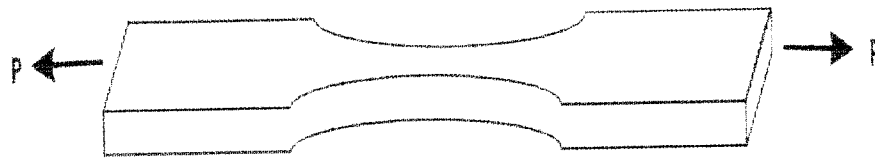
Gambar 4.3 Benda uji tarik pelat baja
