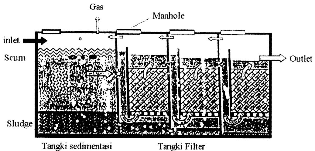
Gambar 3.5. *Filter Anaerobic* (Sasse, 1998)
