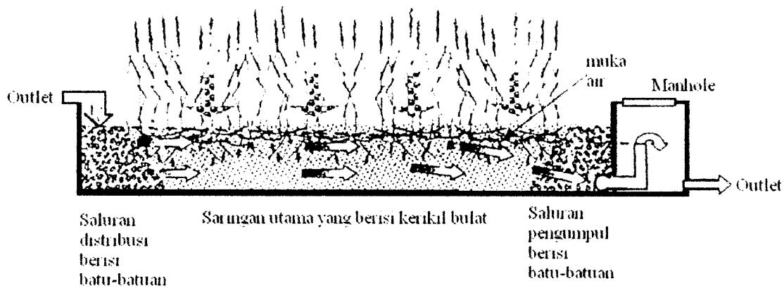
Gambar 3.6. *Filter kerikil horizontal.* (Sasse, 1998)
