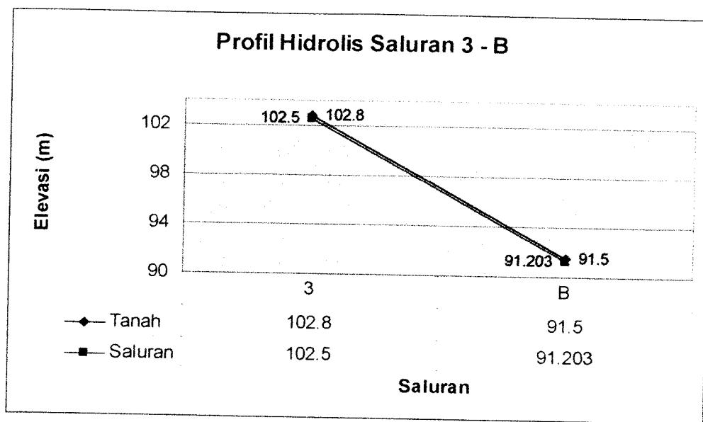
Gambar 7.3. Profil Hidrolis Saluran 3 - B
