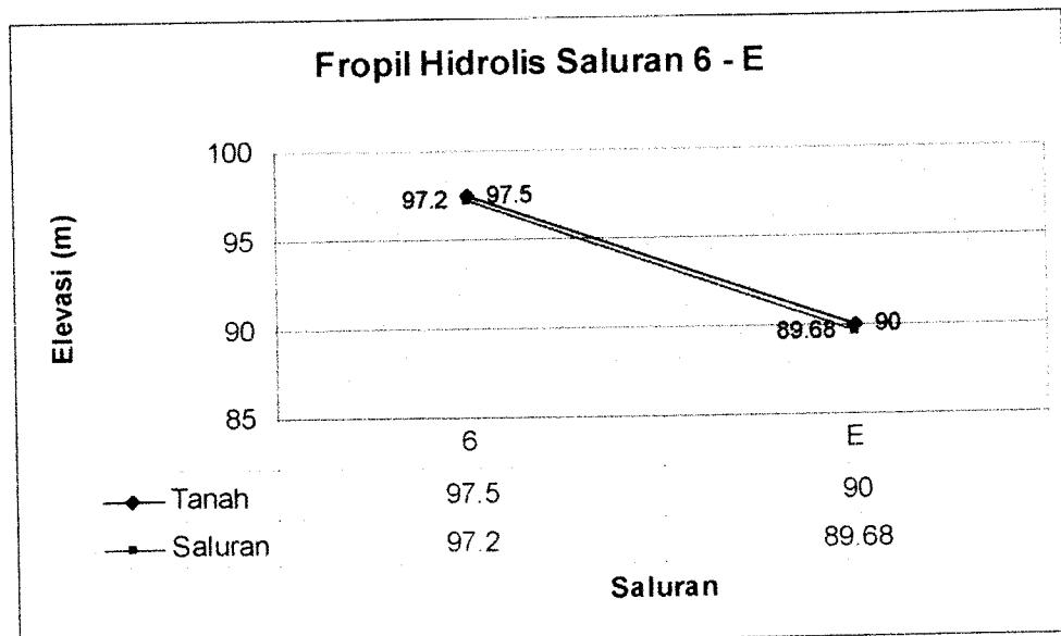
Gambar 7.6. Profil Hidrolis Saluran 6 - E
