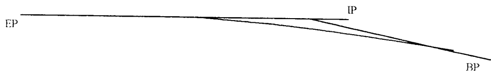
Gambar 5.8 : Lengkung horizontal ramp D
