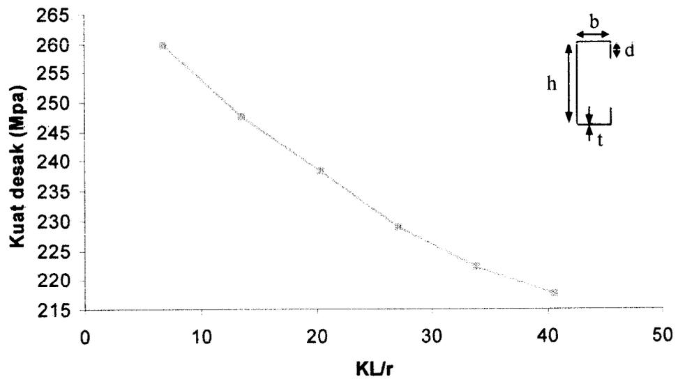
Gambar 5.2. Grafik hubungan kuat desak - KL/r (100x40x8x1,7)
