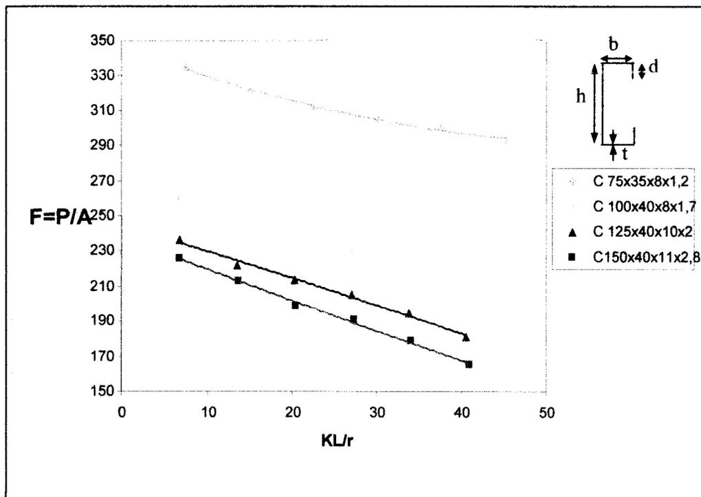
Gambar 5.10. Regresi hubungan kuat desak - KL/r
