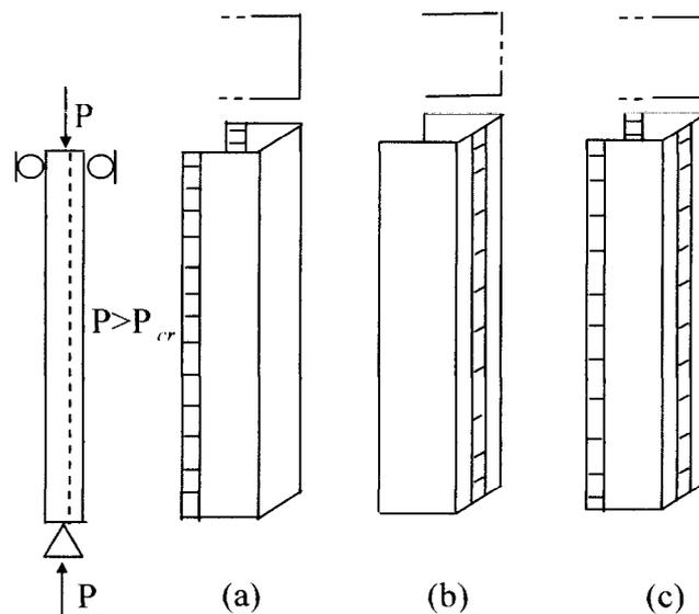
**Gambar 3.5** Penampang kolom profil *channel* di pasca tekuk lokal
