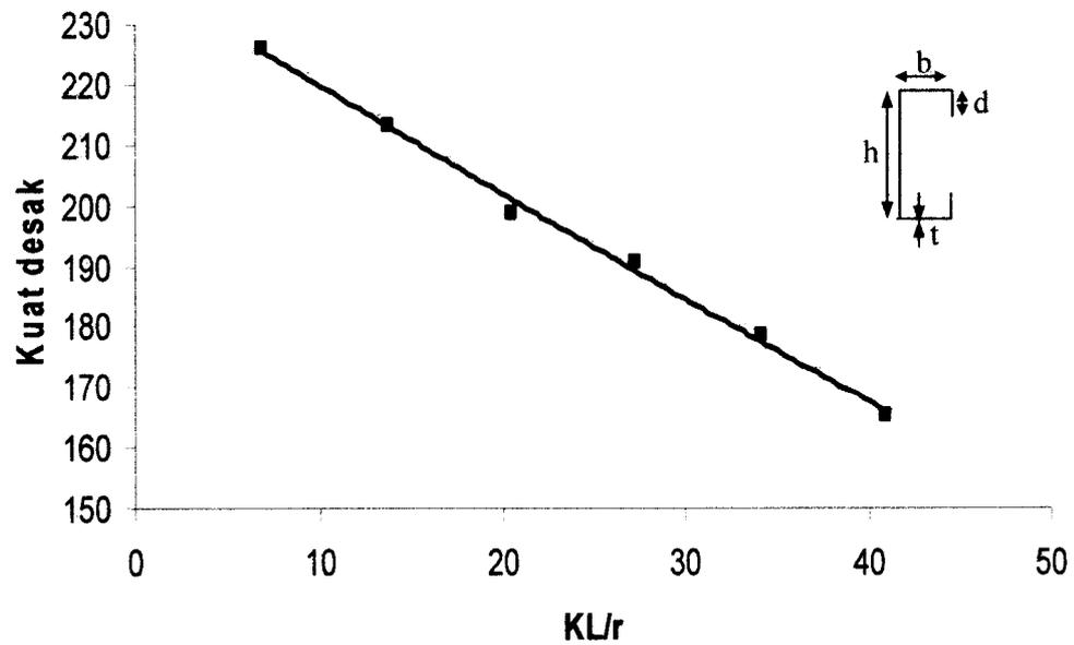
Gambar 5.8 Regresi hubungan kuat desak - KL/r(C 150x40x11x2,8)
