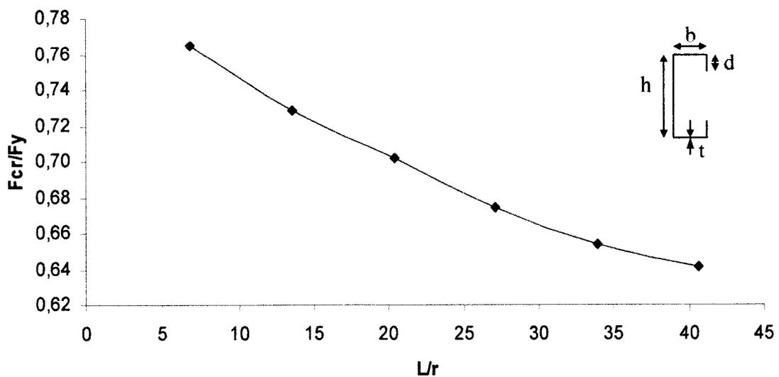
**Gambar 5.12** Kurva hubungan rasio  $F_{cr}/F_y$  terhadap  $L/r$  Profil C100x40x8x1,7
