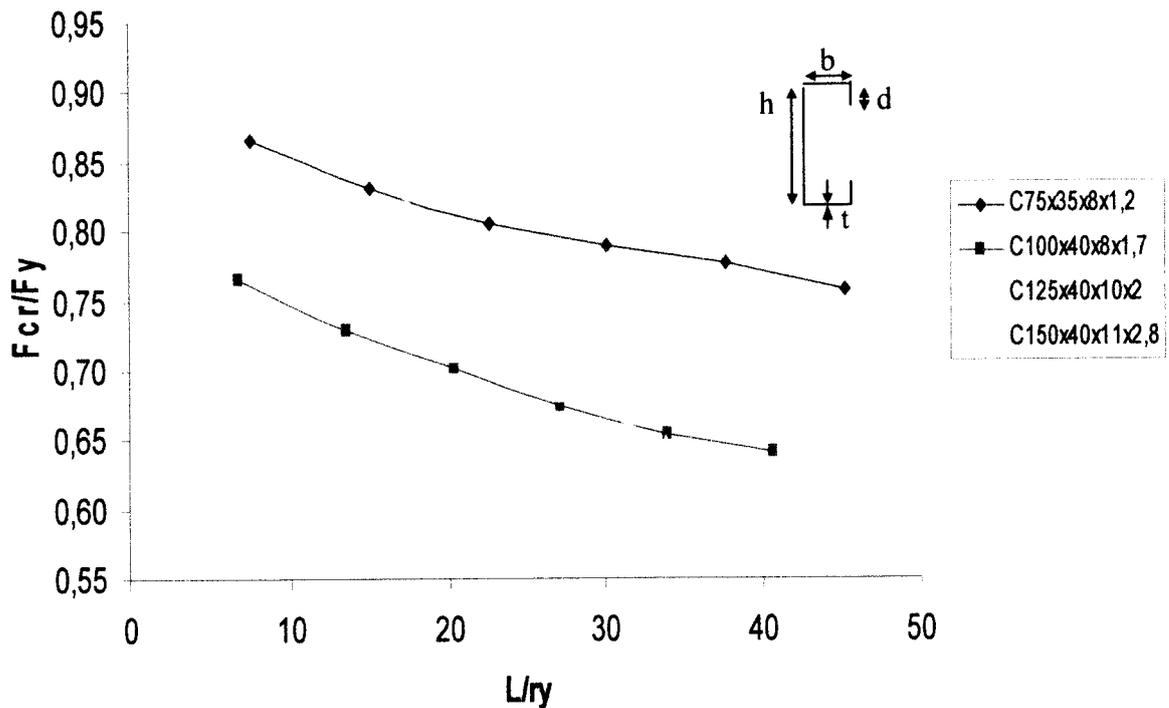
Gambar 5.15 Kurva hubungan rasio  $F_{cr}/F_y$  terhadap  $L/r_y$
