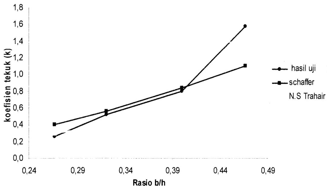
**Gambar 5.18** kurva hubungan nilai koefisien tekuk ( $k$ ) – ( $b/h$ )
