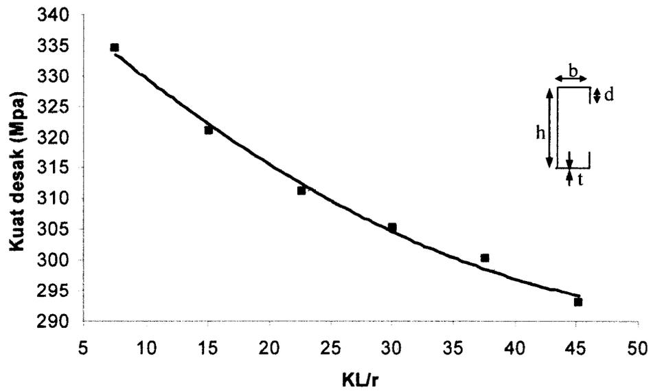
Gambar 5.5 Regresi hubungan Kuat desak -  $KL/r$  (C 75x35x8x1,2)
