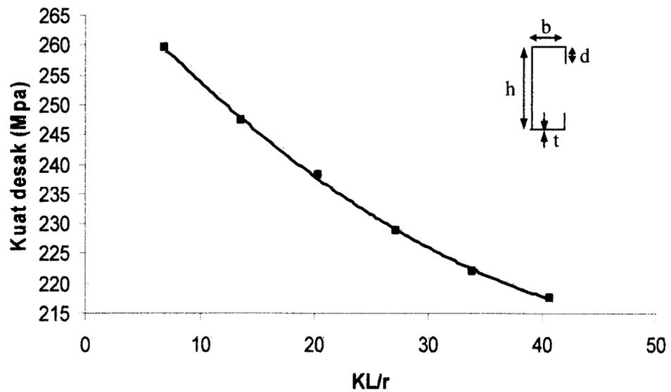
Gambar 5.6 Regresi hubungan kuat desak -  $KL/r$  (C 100x40x8x1,7)
