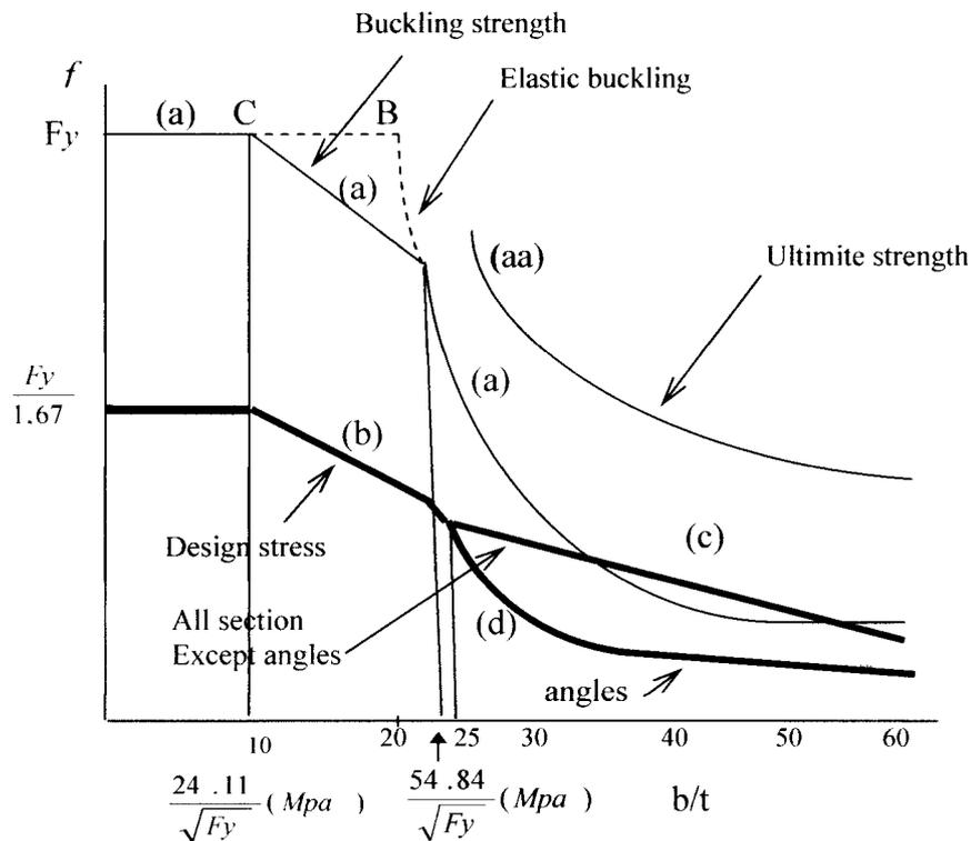
**Gambar 3.10.** Tegangan ijin untuk elemen – elemen tertekan tanpa pengaku. (Country of AISI)
