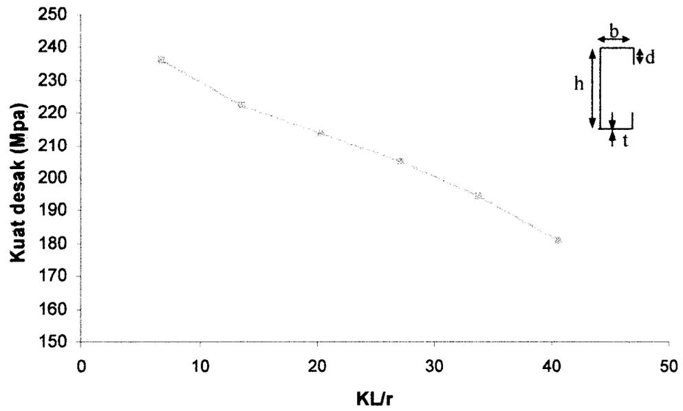
Gambar 5.3 Grafik hubungan kuat desak - KL/r(C125x40x10x2)
