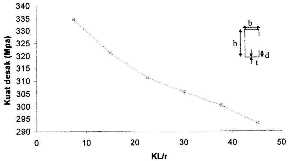
Gambar 5.1 Grafik hubungan Kuat desak - KL/r (75x35x8x1,2)
