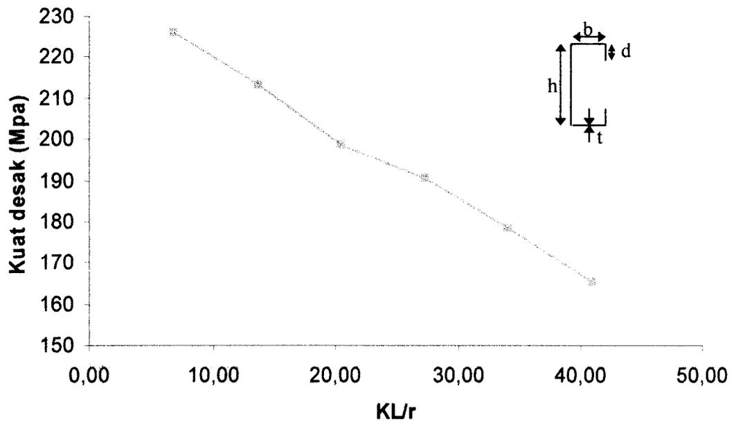
Gambar 5.4. Grafik hubungan kuat desak - KL/r (150x40x11x2,8)
