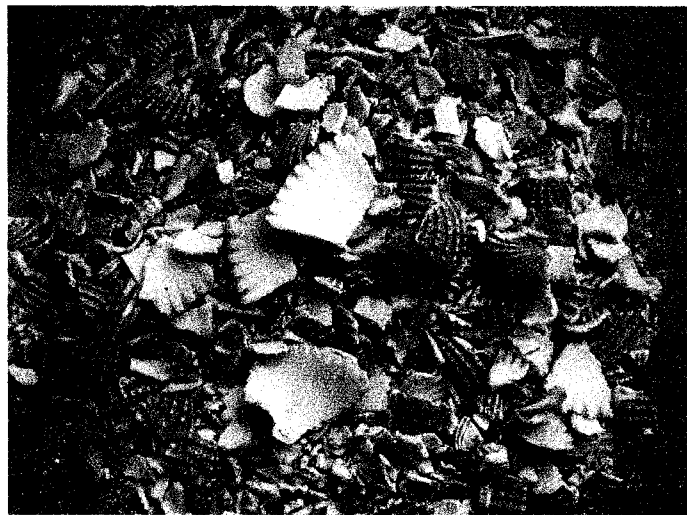
Gambar 4. Serbuk kulit kerang sesudah di Stone Crusher
