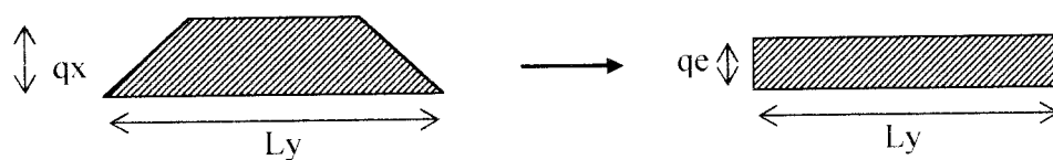
Gambar 5.3 Ekuivalensi beban trapesium ke beban merata
