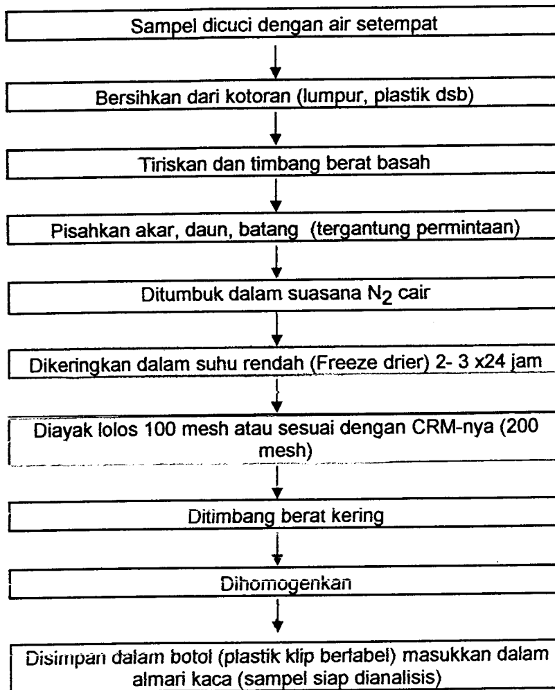
Gambar 3.4. Skema Metode Preparasi Sampel Tanaman Air Sumber : Laboratorium DIB Bidang Teknofisika Kimia (P3TM BATAN)
