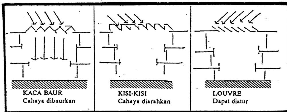
Gambar 2.5. Sistem Penerangan Alami Melalui Skylight
