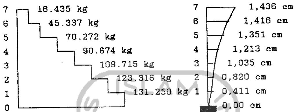
Gambar 3.10. Diagram gaya geser dan diagram defleksi horizontal untuk portal tanpa dinding geser.
