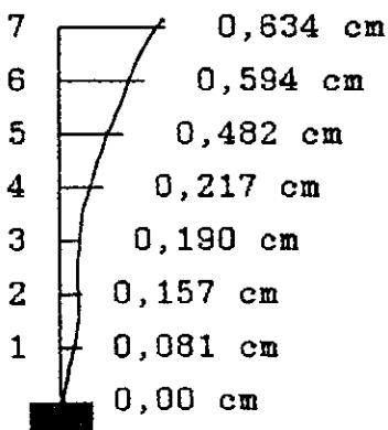
Gambar 3.13. Diagram defleksi horizontal ( $\delta_i$ ) setelah ukuran balok dan kolom diubah.
