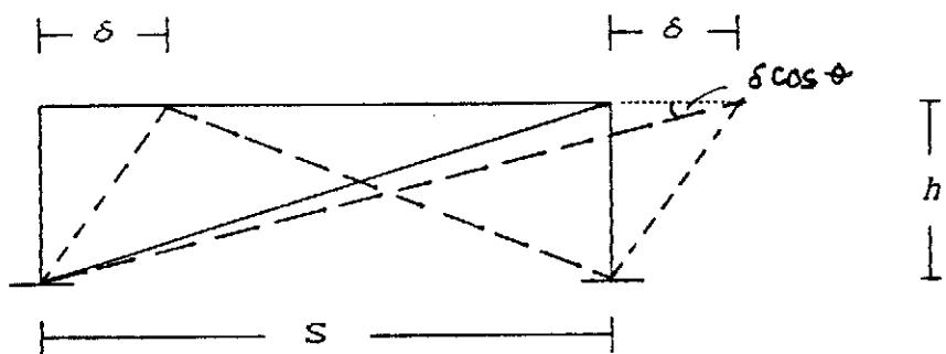
Gambar 2.8. Gaya horizontal pada portal dengan "diagonal bracing"
