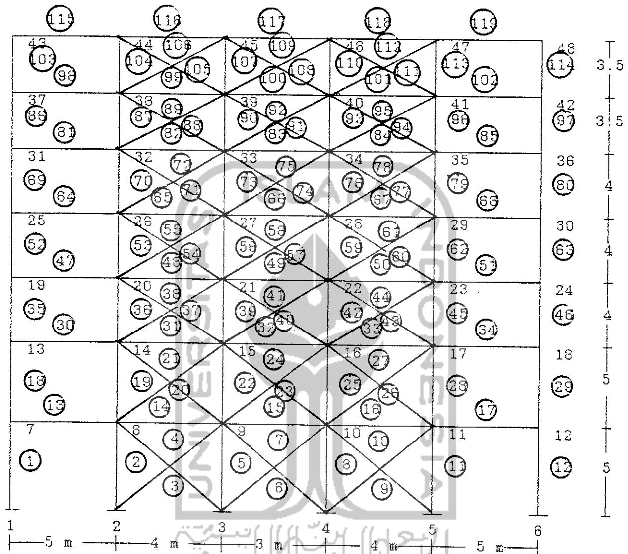
Gambar 4.6. Penomoran titik joint & batang portal terbuka dengan dinding geser dianggap sebagai equivalent bracings (kondisi 2)
