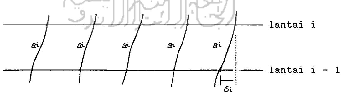
$$\delta_i = \frac{Q}{k} \quad \text{dimana } Q = \text{jumlah beban horizontal pada lantai } i \text{ dan lantai di atasnya}$$
