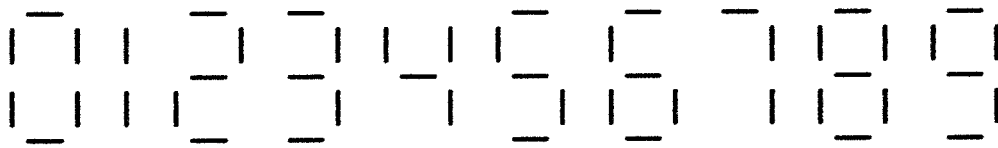
Gambar 2.12 Tujuh segmen dalam digit desimal
