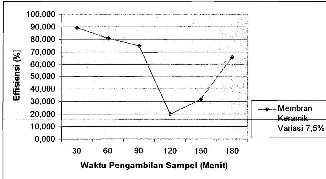
**Gambar 4.12. Efisiensi Membran Keramik Variasi Serbuk Gergaji 7,5% Dalam Penurunan *Chemical Oxygen Demand* (COD)**
