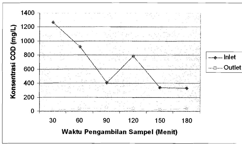
**Gambar 4.7. Penurunan COD Dengan Membran Keramik Variasi Serbuk Gergaji 2,5 %**
