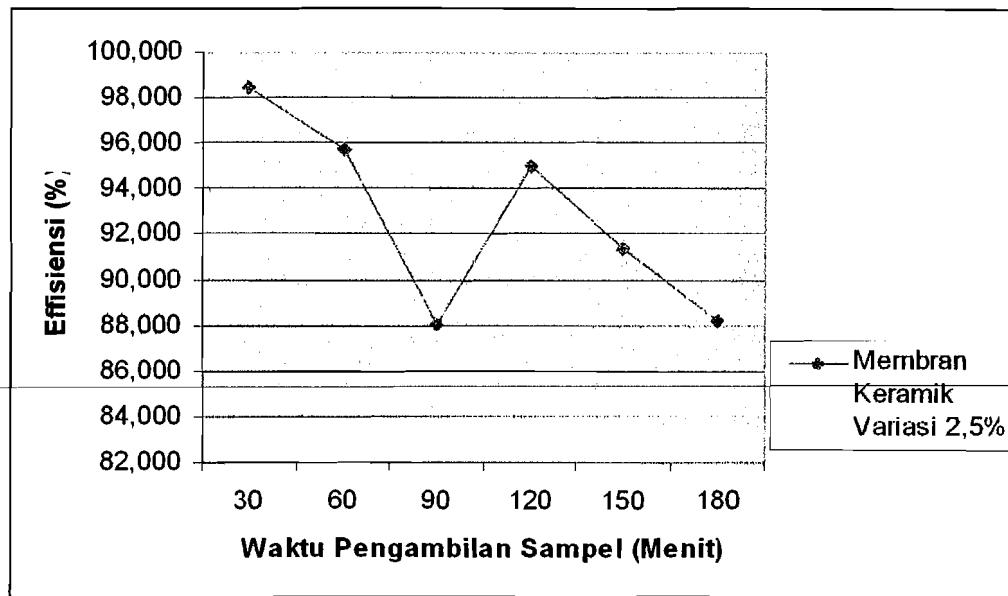
**Gambar 4.8. Efisiensi Membran Keramik Variasi Serbuk Gergaji 2,5% Dalam Penurunan *Chemical Oxygen Demand* (COD)**
