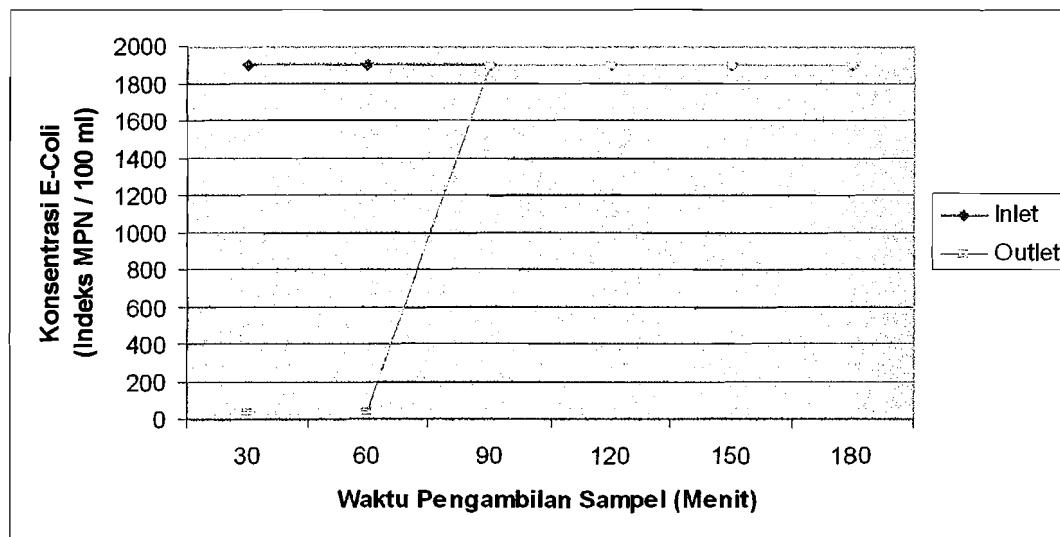
**Gambar 4.5. Penurunan Bakteri E-Coli Dengan Membran Keramik Variasi Serbuk Gergaji 7,5%**
