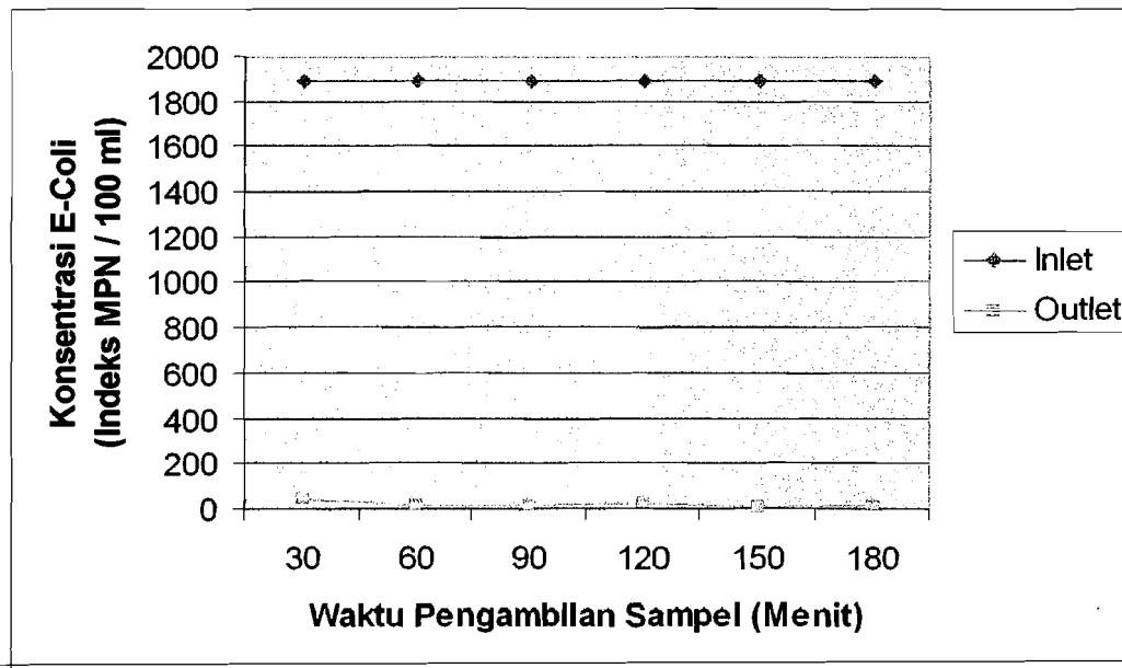
**Gambar 4.1. Penurunan Bakteri E-Coli Dengan Membran Keramik Variasi Serbuk Gergaji 2,5 %**
