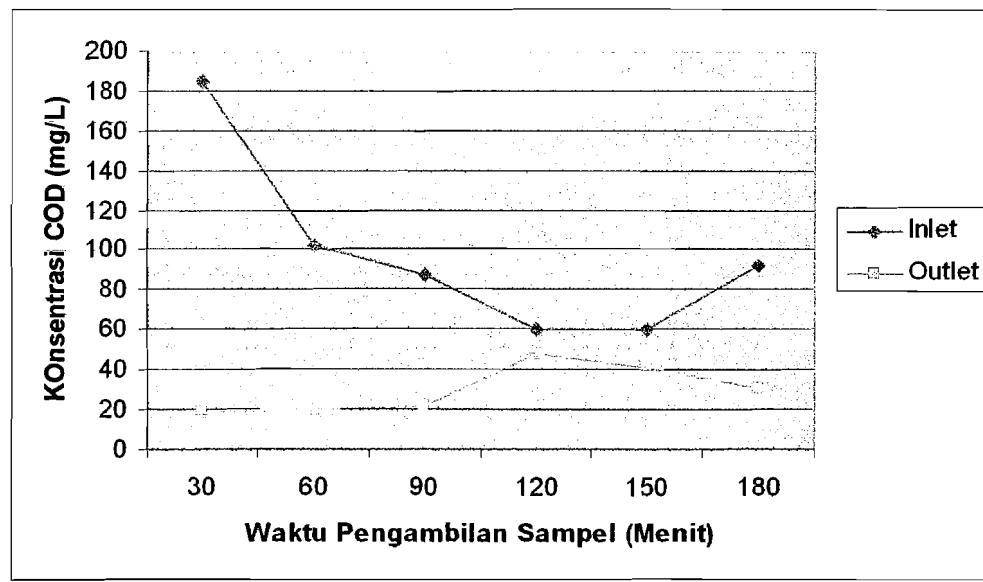
**Gambar 4.11. Penurunan COD Dengan Membran Keramik Variasi Serbuk Gergaji 7,5%**
