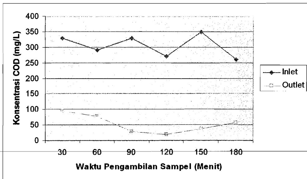
**Gambar 4.9. Penurunan COD Dengan Membran Keramik Variasi Serbuk Gergaji 5%**
