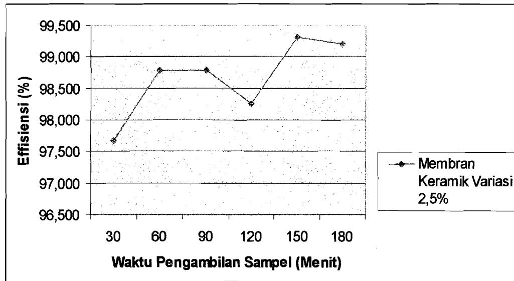
**Gambar 4.2. Efisiensi Membran Keramik Variasi Serbuk Gergaji 2,5% Dalam Penurunan Bakteri E-Coli**
