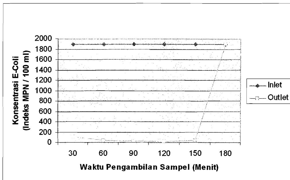
**Gambar 4.3. Penurunan Bakteri E-Coli Dengan Membran Keramik Variasi Serbuk Gergaji 5%**
