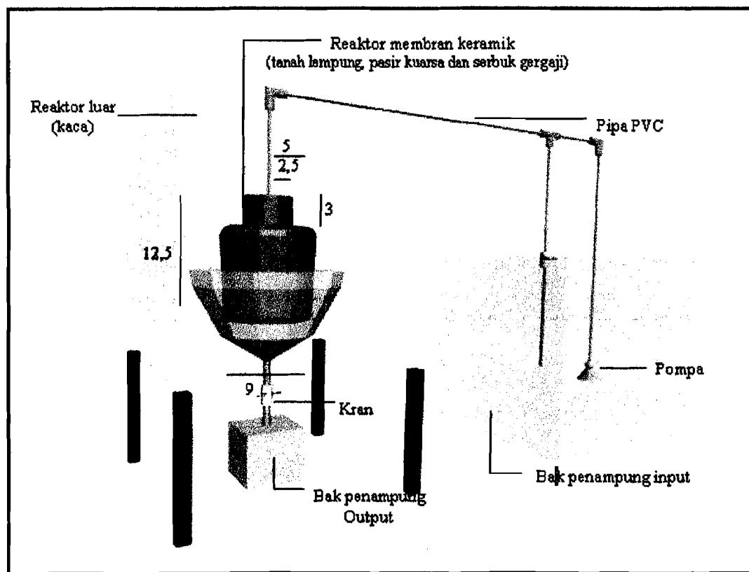
**Gambar 3.1. Reaktor Membran Keramik**
