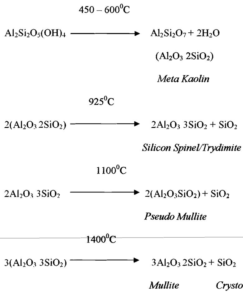
**Gambar 2.1. Proses Perubahan Bentonit Alam Dalam Pembakaran
