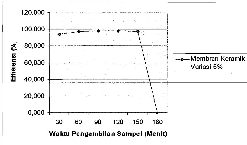
**Gambar 4.4. Efisiensi Membran Keramik Variasi Serbuk Gergaji 5% Dalam Penurunan Bakteri E-Coli**
