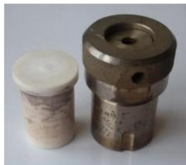
Gambar 3. Autoklaf (alat sintesis secara hidrotermal)
