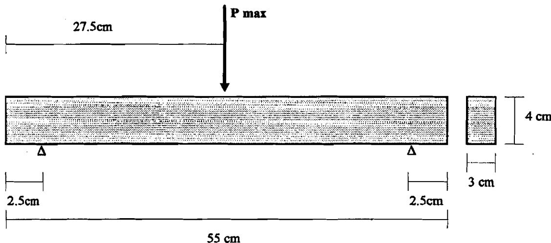
**Gambar 4.5. Sket Perletakan dan Pembebanan Pada Balok Uji**
