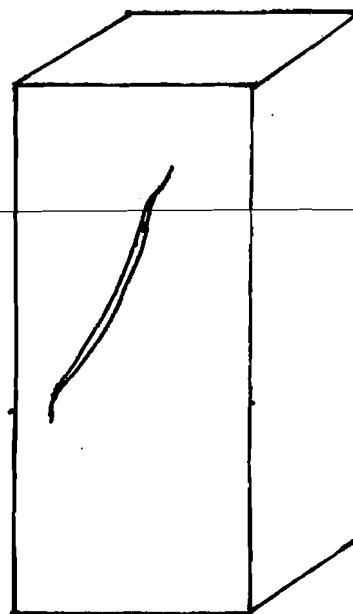
**B. BENDA UJI DESAK TEGAK LURUS SERAT SESUDAH PENGUJIAN**
