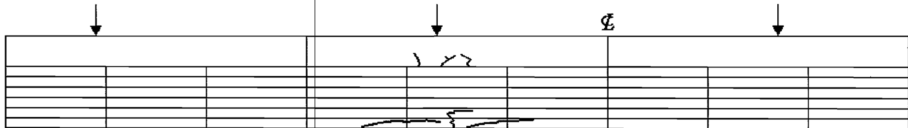
Detail pola retak dan patah KKB - II
