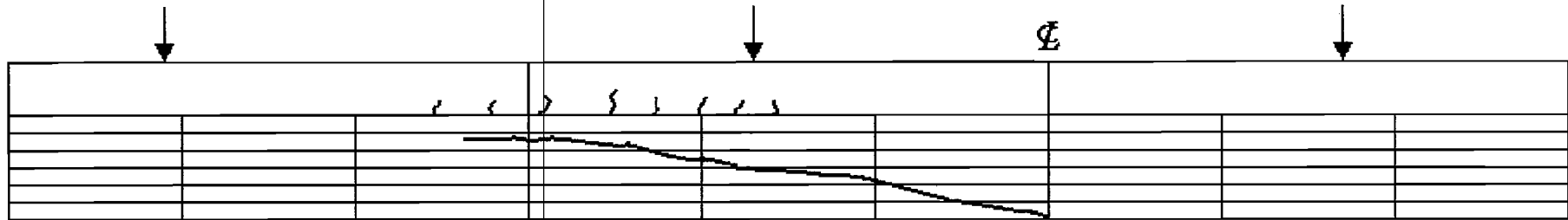
Detail pola retak dan patah KKB - I
