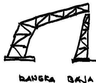
Pada bagian tertentu terdapat perpaduan sistem struktur yaitu sistem rangka beton dan baja hal ini karena tuntutan bentuk estetika dan fungsi yaitu pada lengkung diatas void. Untuk atap karena dibawahnya untuk pameran maka digunakan bentang lebar kuda-kuda baja.
