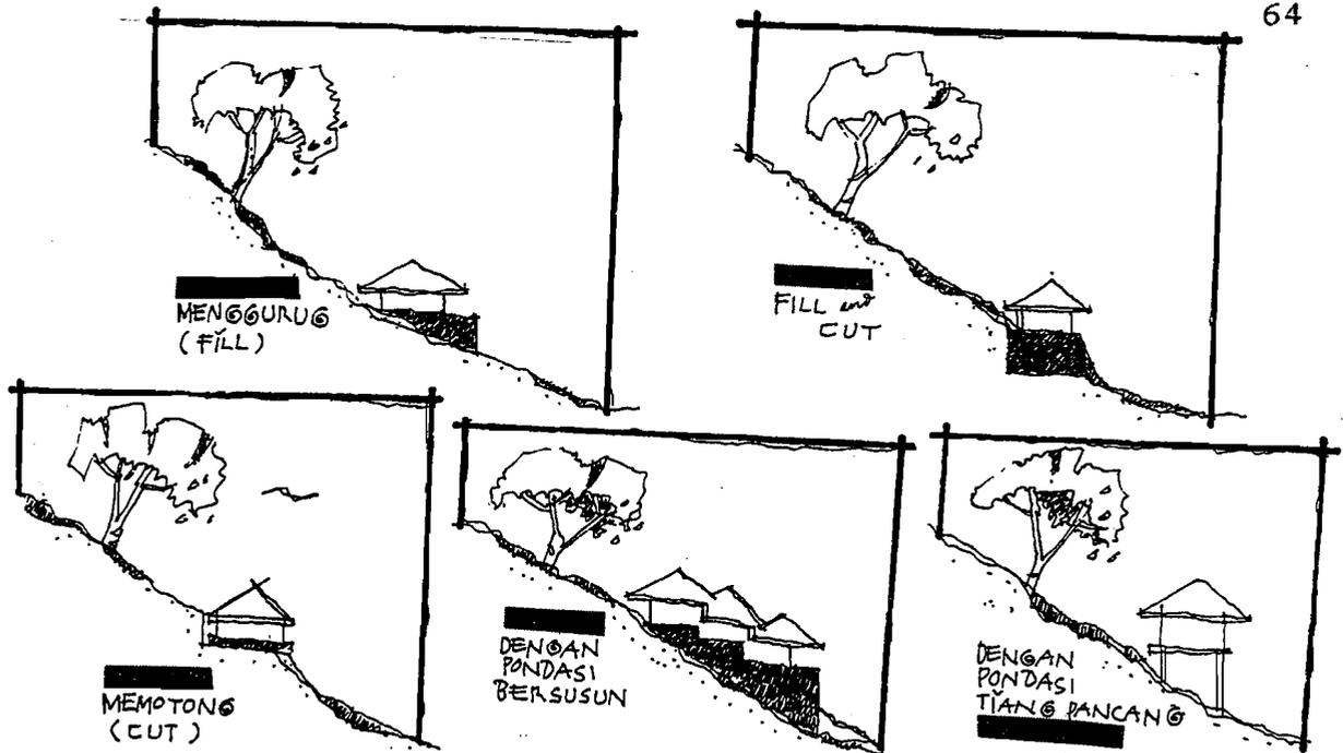
Gambar 3.8. *Perlakuan Kontur Tanah Pada Bangunan*
