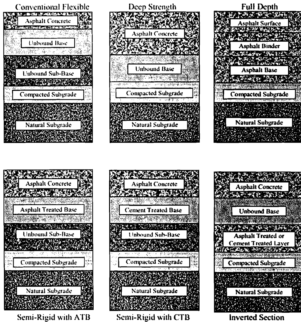
Gambar 3.2 Ilustrasi Beberapa Alternatif Lapis Perkerasan Lentur Sumber : AASHTO Design Guide 2002
