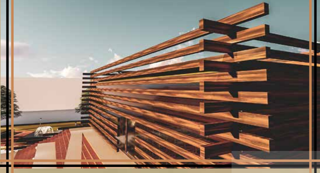
Detail pada fasad bangunan menggunakan perpaduan kayu yang melindungi dan memberikan kenyamanan pengguna didalam bangunan sebagai second skin.
