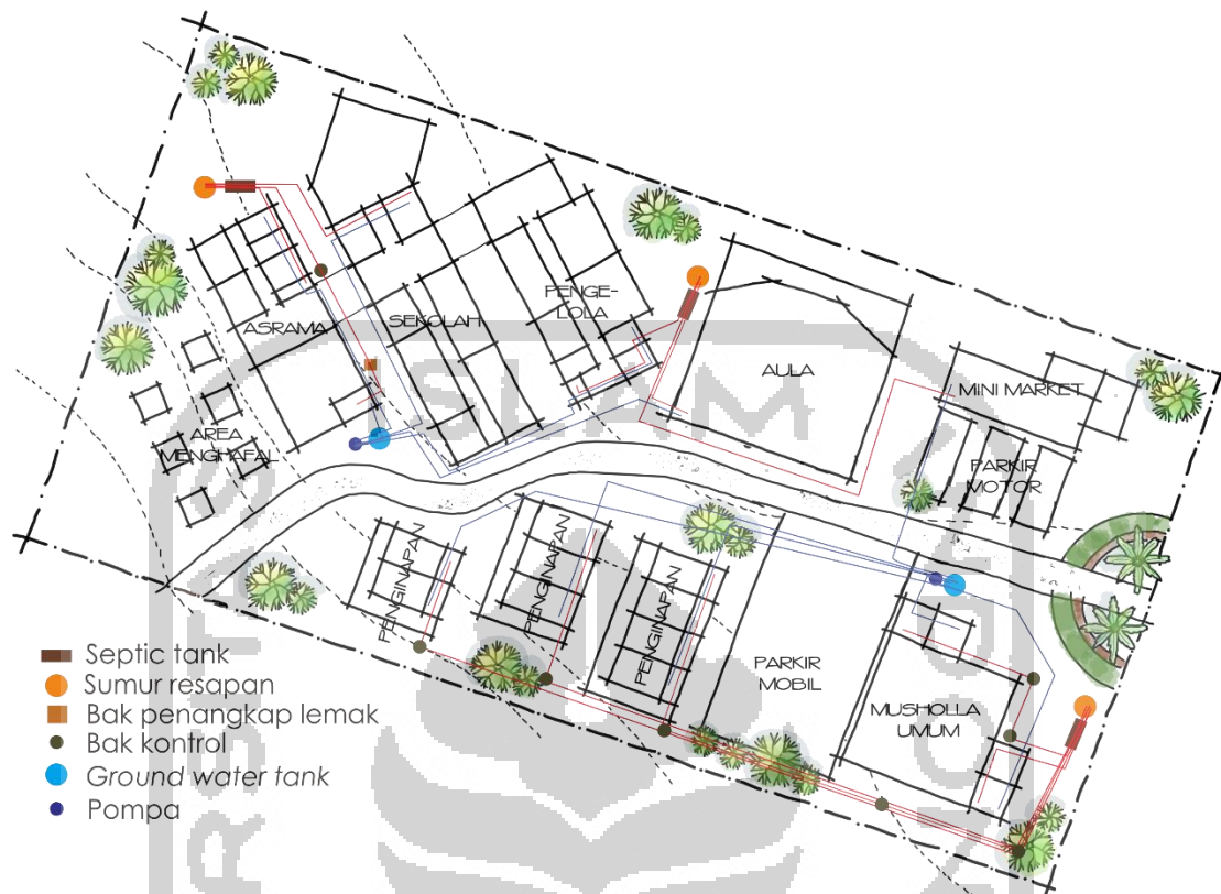
Gambar 100. Skema sistem utilitas pada site Sumber: (Penulis, 2019)
