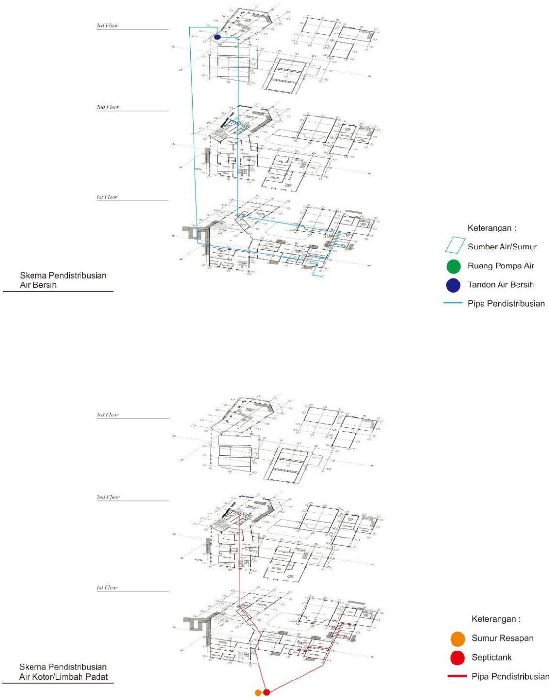
Gambar 5.8 Sistem Air Bersih dan Air Kotor (Sumber: Penulis, 2019)
