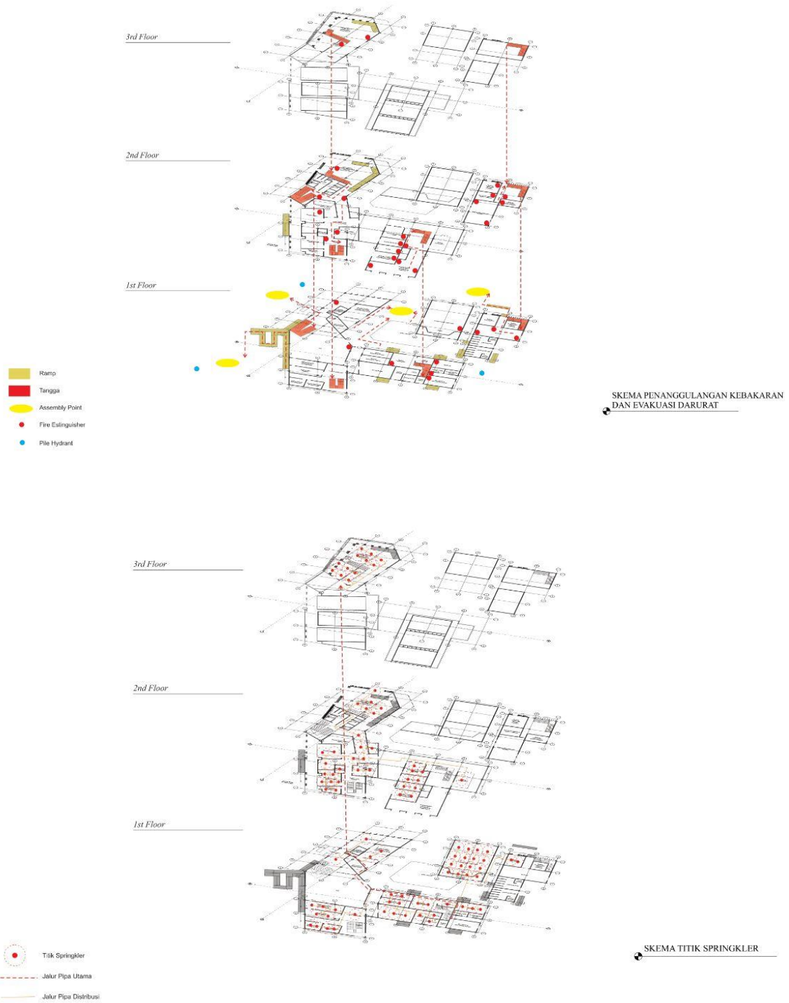
Gambar 5.10 Sistem Penanggulangan Kebakaran dan Evakuasi
