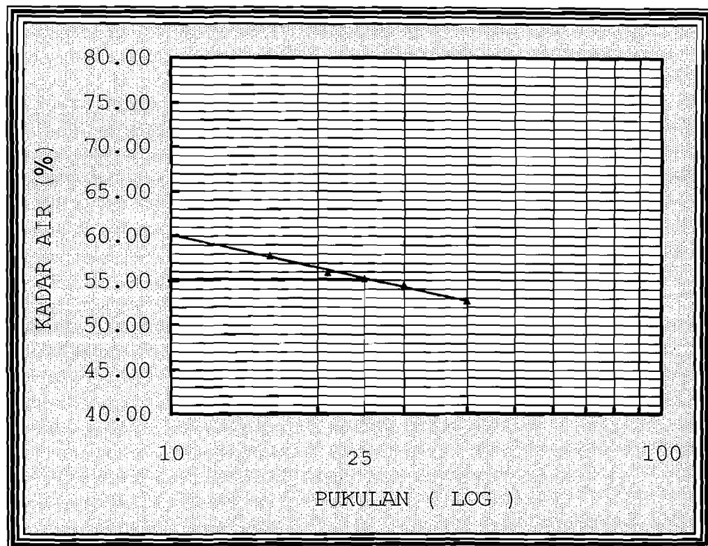
Gambar 5.4 Grafik hubungan antara pukulan dengan kadar air
