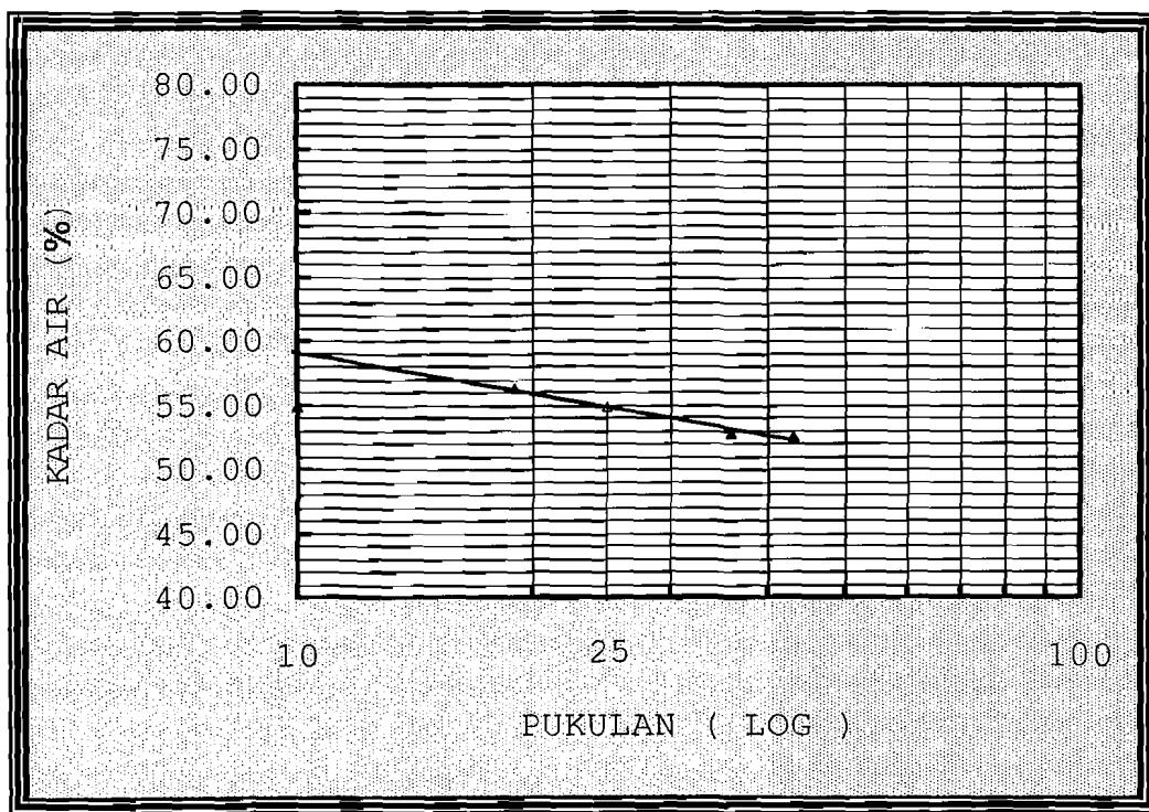
Gambar 5.3 Grafik hubungan antara pukulan dengan kadar air
