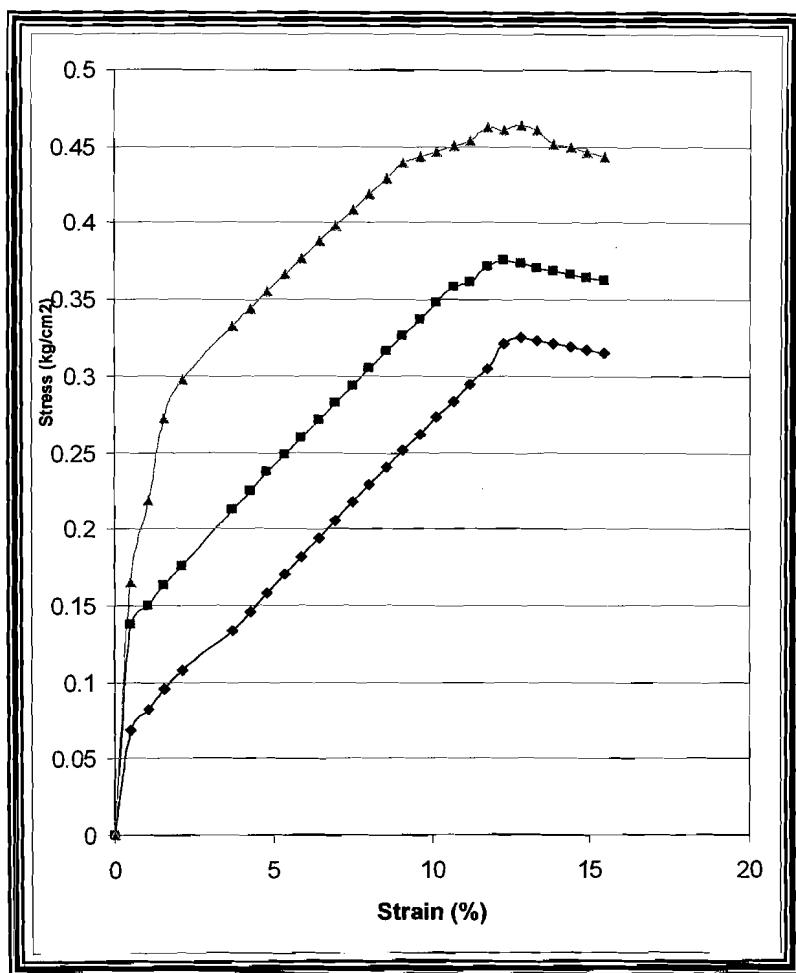
**Gambar 5.9** Kurva hubungan Tegangan dan Regangan pada uji Triaksial Tanah Asli II
