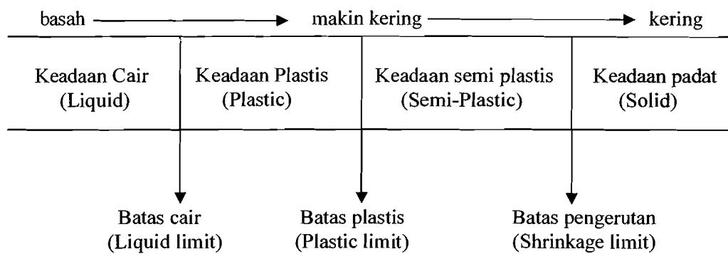
**Gambar 3.4** Batas konsistensi tanah
