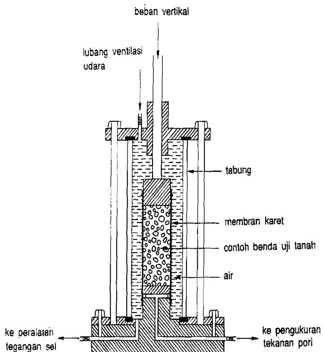
**Gambar 4.1** Diagram skematis dari peralatan pengujian Triaksial
