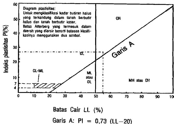
**Gambar 6.2 Klasifikasi tanah berdasarkan sistem *Unified***
