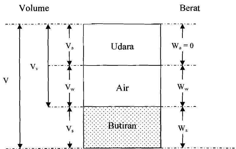
**Gambar 3.1** Diagram Fase Tanah
