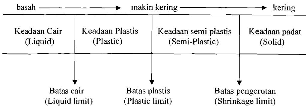
**Gambar 3.4** Batas konsistensi tanah
