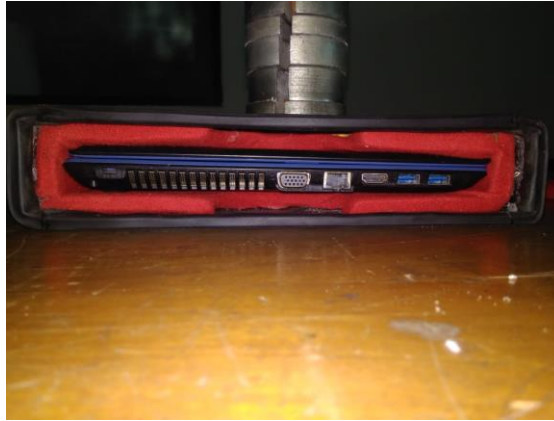
Gambar 4.8 Defleksi pada pengujian kedua
