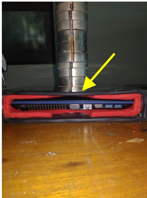
Gambar 4.7 Defleksi pada pengujian pertama
