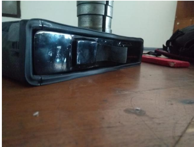
Gambar 4.10 Defleksi pada pengujian keempat
