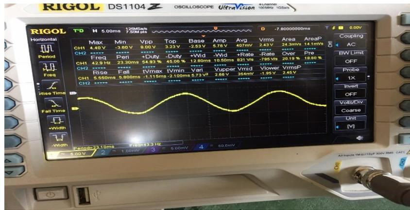
Gambar 4.4 Sinyal Tegangan Beban Induktif
