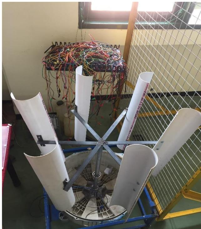
Gambar 3.4 Prototipe Turbin Angin
