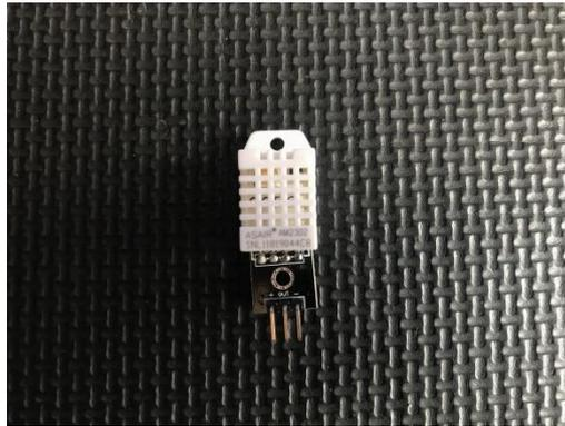
Gambar 2.2 Modul DHT22
