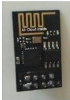
Gambar 2.4 Modul ESP 8266
