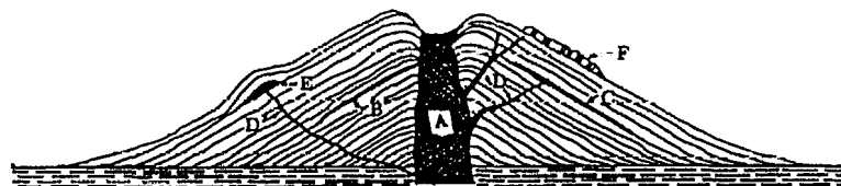
Gambar 15. Penampang diagramatik gunung api gabungan yang menunjukkan adanya (A) sumbat (B) sill selubung, (C) sill, (D) retas, (E) lakolit dan (F) aliran lava, menurut McDonald (1972)
