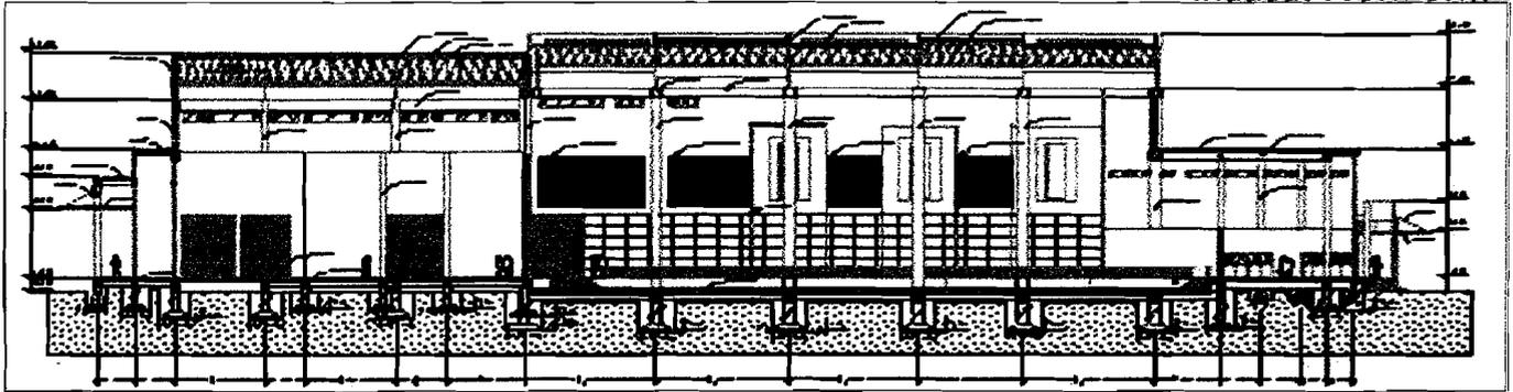
Pada potongan horizontal bangunan produksi sistem struktur yang dipakai terdiri dari beton bertulang, pondasi footplat, rangka baja serta bahan atap dari metaldeck, bangunan rata-rata memiliki ketinggian hingga 15 meter hal ini dipilih karena guna mempertimbangkan masalah penghawaan, kebisingan serta keleluasaan dalam bekerja, selain itu juga karena peralatan yang digunakan guna industri relatif besar.
