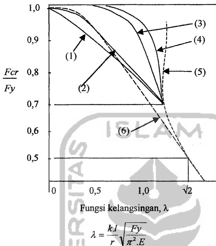
Gambar 2.9. Kurva kekuatan kolom Profil I yang memiliki tegangan residu pada ujung sayap
