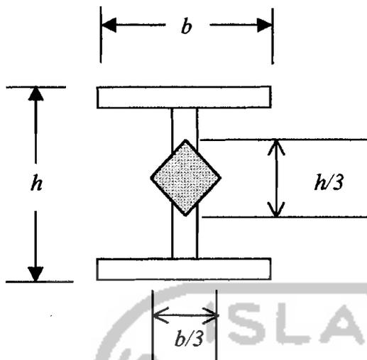
Gambar 2.16. Batas daerah kern penampang profil W.
