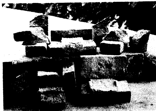
Gambar A.12 Hasil pengujian lekatan bata dan mortar
