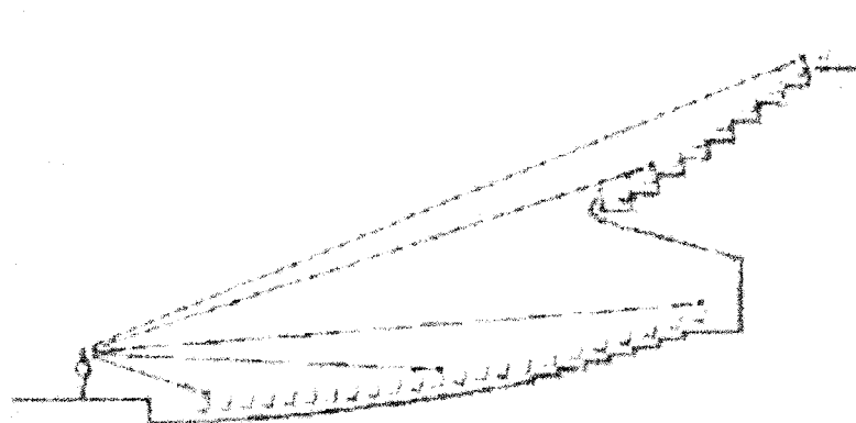
Gambar 2.18 Gelombang Bunyi Merambat Secara Langsung Sumber : Leslie Doelle, "Akustik Lingkungan" 1990
